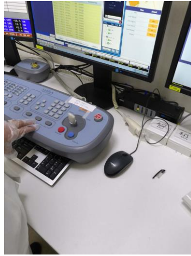
图 3-27 控制室急停按钮
