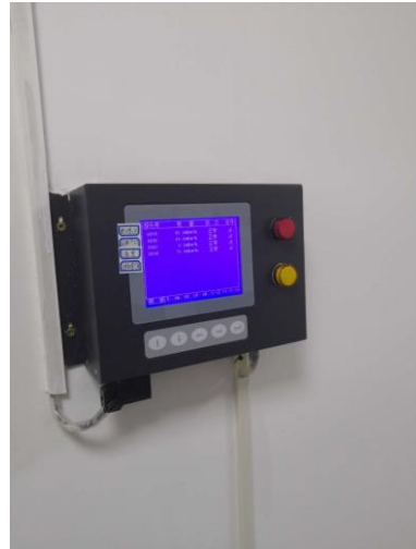
图 3-9 4 探头 \gamma 辐射监测报警仪
